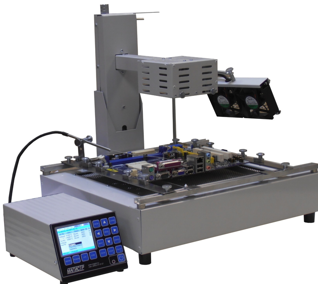
Фото 1. Общий вид станции с нижним ИК-излучателем
