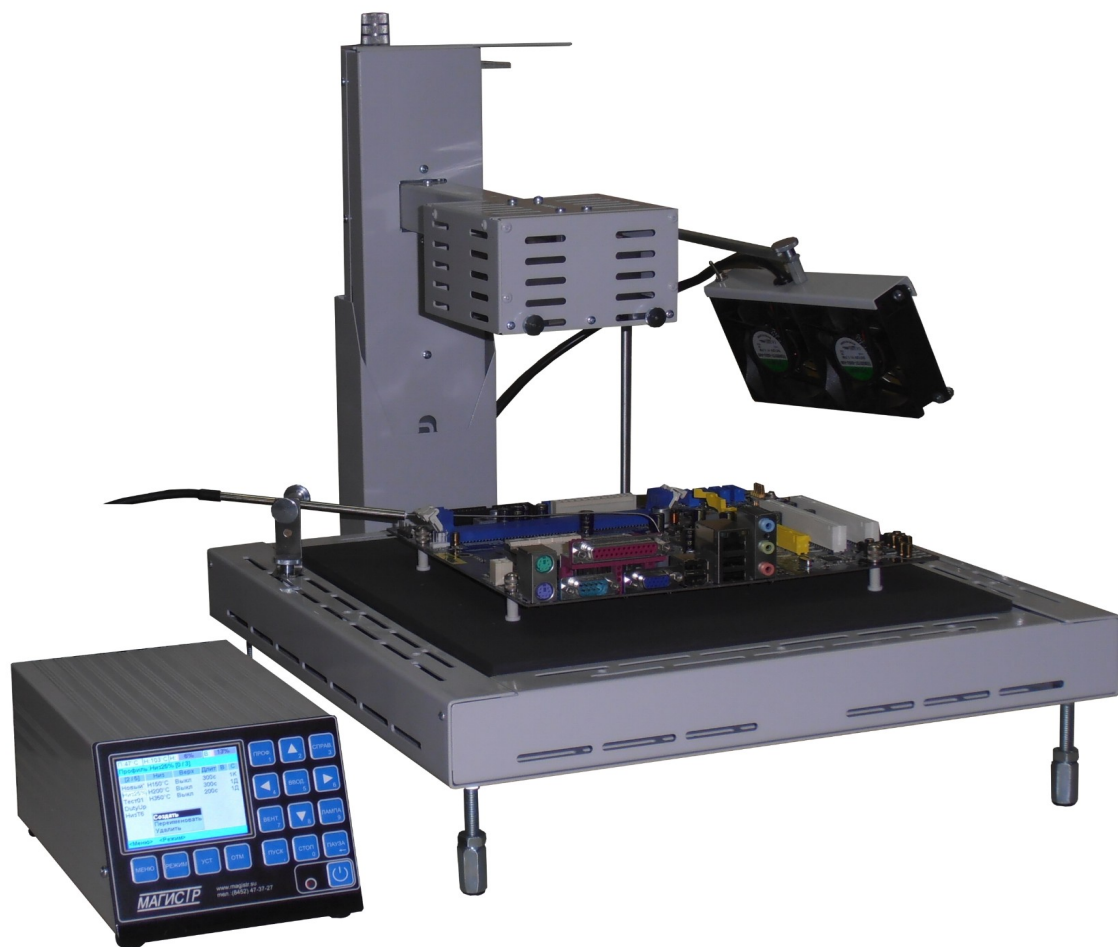
Фото 2. Общий вид станции с нижним термостолом
